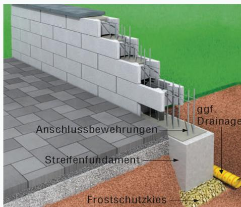
Nach dem Aufbau wird die erforderliche Bewehrung eingebaut und an der horizontalen Bewehrung mittels Bindedraht so oft wie möglich fixiert.
