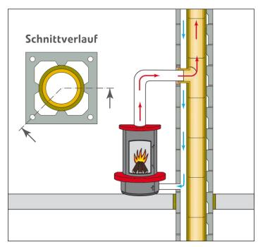
Die ideale Lösung beim konzentrischen Kaminsystem: Im geschlossenen Kreislauf wird die Verbrennungsluft zum raumluft<u>unabhängigen Ofen geführt und die Abgase werden sicher</u> abtransportiert.
