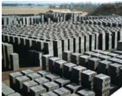
Zur weiteren Erhärtung und Trocknung lagern die Steine bis zum Versand im Freien.
