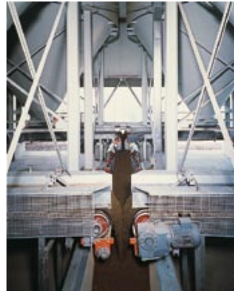
Unterschiedliche Bimsrohstoffe werden nach speziellen Rezepturen gemischt und aufgegeben.
