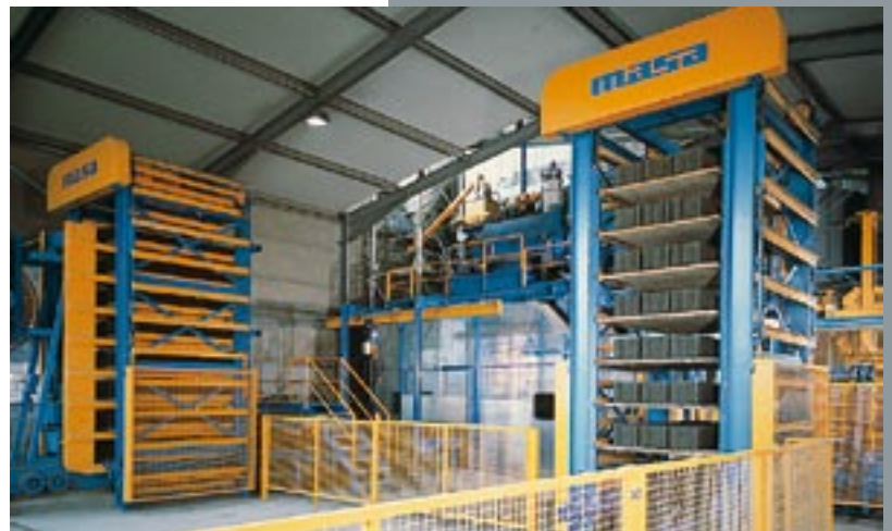
In Formen gefüllt wird nur durch Vibration aus dem plastischen Leichtbeton ein fertiger Stein. Ein Brennvorgang ist nicht nötig.
