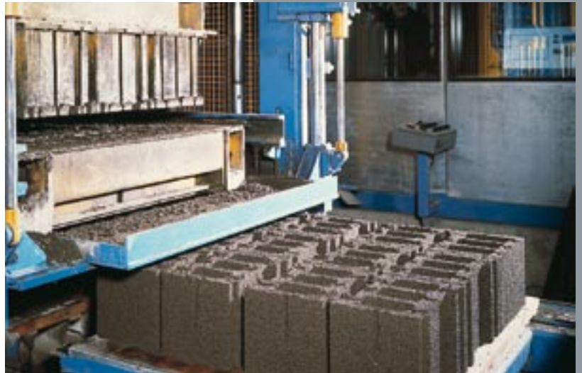
Blick in die Produktionshalle mit der vollautomatisch arbeitenden und comutergesteuerten Ringanlage.
