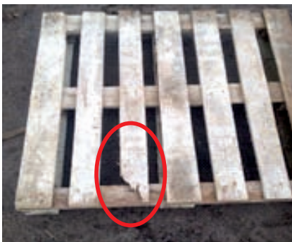
Beispiele reparaturfähiger Paletten
