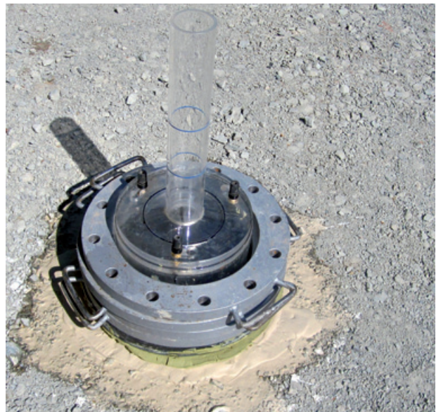
Bild 24: Bestimmung des Infiltrationsbeiwertes auf einer Tragschicht ohne Bindemittel (in situ) mit dem modifizierten Standrohr-Infiltrometer nach den TP Gestein-StB Teil 8.3.2
