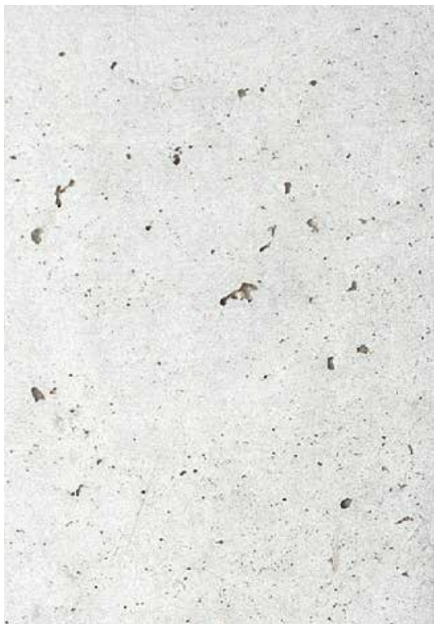
Beton mit gefügedichter Oberfläche
