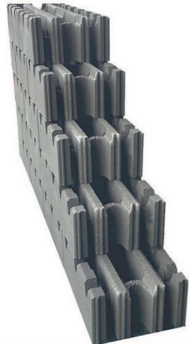
Aufgrund der drei Kammern lässt sich das Green Wall-Kombi Mauersystem außen ein- oder zweiseitig begrünen und innen ausbetonieren. (Bild: Jasto Baustoffwerke)
